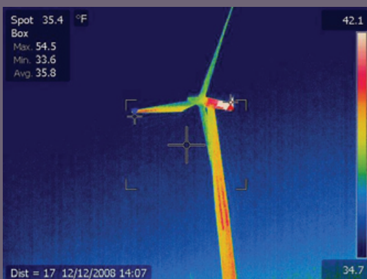
ИК-изображение ветровой турбины, полученное с земли
