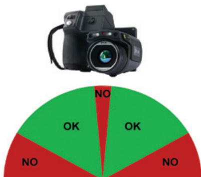
Рекомендуемый (зеленый) и нерекомендуемый (красный) углы съемки во время термографических осмотров.
