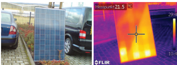
Проверка солнечной панели показывает, что горячие точки хорошо видны на термическом изображении, сделанном даже с лицевой стороны.
