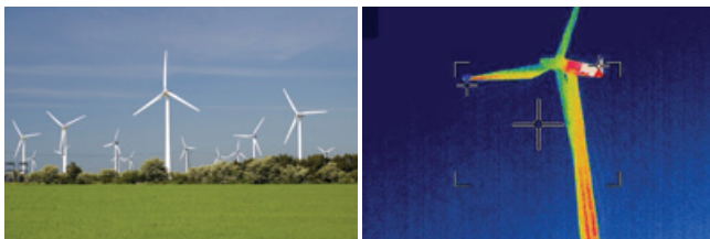
ИК-изображение ветровой турбины, полученное с земли
