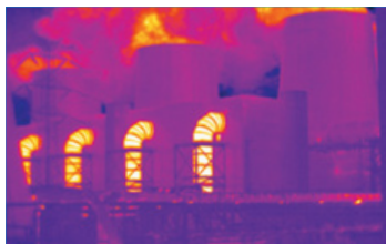
Потери тепла в паровой установке из-за недостаточной изоляции
