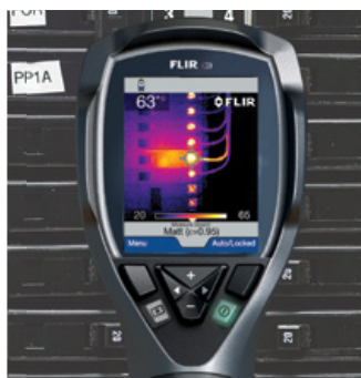
FLIR i3: измерение температуры в 3 600 точках
