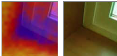
Потенциальная утечка тепла из дверей и окон
