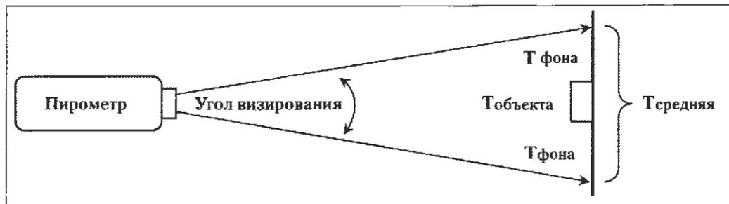
Рис. 7.3. Иллюстрация погрешности измерения температуры пирометром
