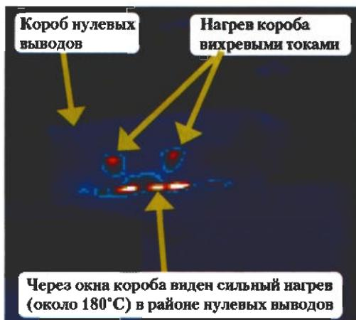
Рис. 14.12. Термограмма нагревов в районе "нулевых" выводов турбогенератора мощностью 500 МВт
