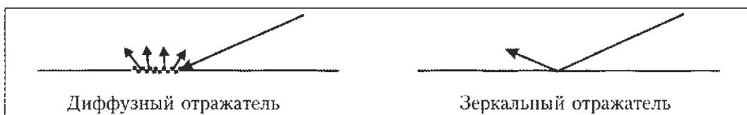
Рис. 10.5. Отраженное излучение от зеркального и диффузного отражателя
