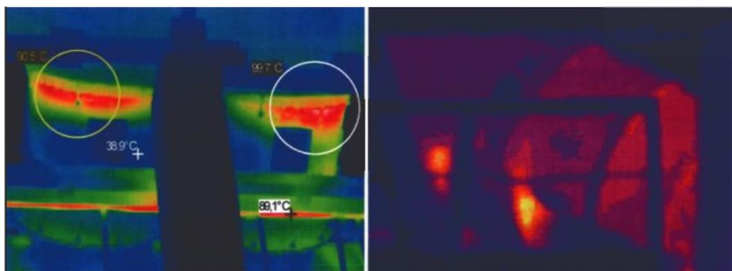
в) местные нагревы стальных конструкций (поручней ограждения) из-за наличия сильного внешнего магнитного поля КЭТ.
