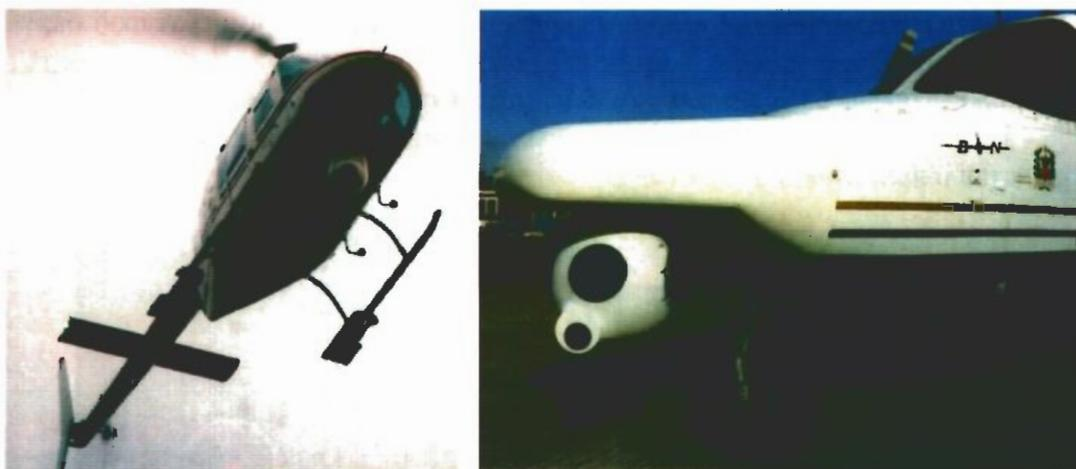
Рис. 14.45. Установка гиросtabilизированной платформы с тепловизором на вертолете (вверху) и легком самолете (внизу)
