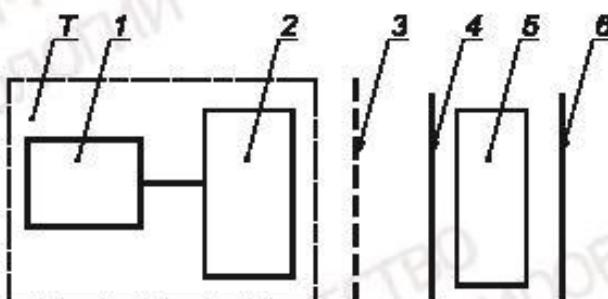
T — испытуемый тепловизор (1 — блок регистрации, 2 — оптическая головка); 3 — нейтральный ослабляющий фильтр; 4 — штриховая мири; 5 — излучатель-термостат; 6 — экран-фон
