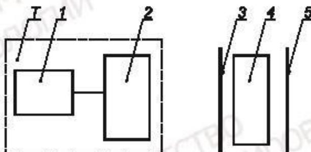
T — испытуемый тепловизор (1 — блок регистрации, 2 — оптическая головка); 3 — тест-объект в виде миры с метками и отверстиями; 4 — излучатель-термостат; 5 — экран-фон
