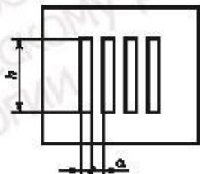
$N\alpha = 7$ ;  $a_1 = 1 \text{ мм}$ ;  $a_2 = 2 \text{ мм}$ ;  $a_3 = 4 \text{ мм}$ ;  $a_4 = 8 \text{ мм}$ ;  $a_5 = 16 \text{ мм}$ ;  $a_6 = 32 \text{ мм}$
