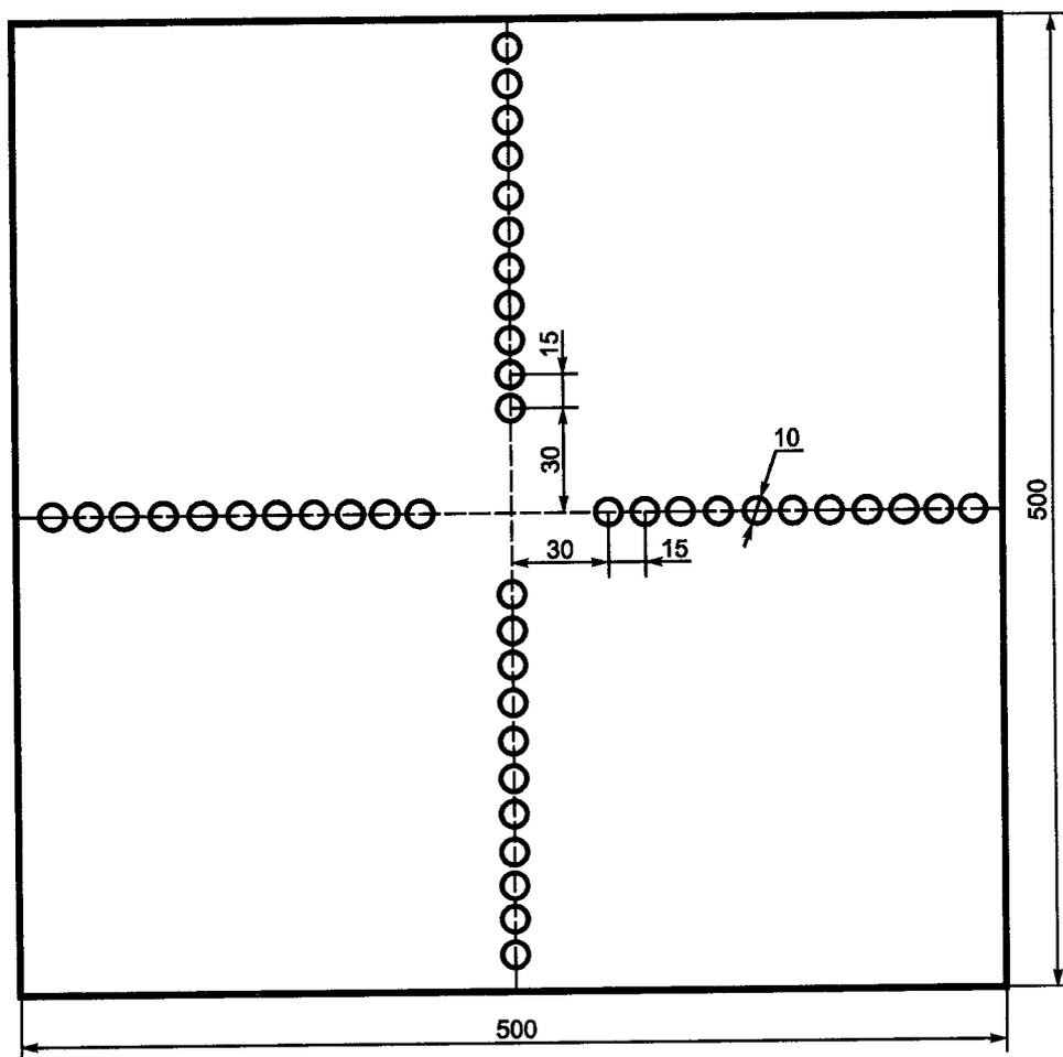
$d$  — диаметр отверстия (10 мм). Толщина тест-объекта 1 мм. Одна сторона полированная, другая подлжет чернению
