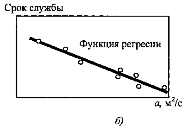
Рис. 9.50. Оценка срока службы режущего инструмента по теплопроводности: а – регистрируемый температурный сигнал, б – функция регрессии
