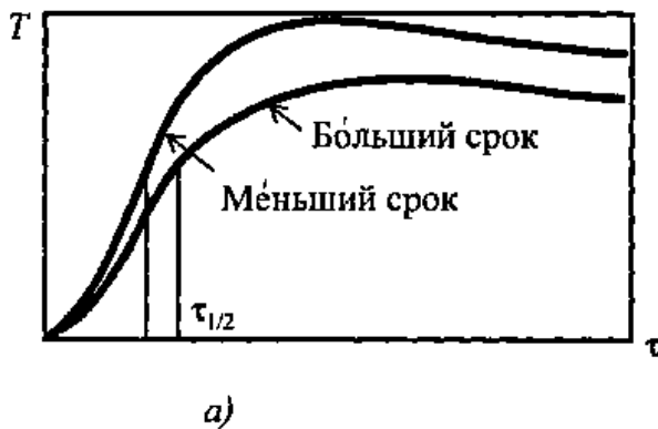
Рис. 9.50. Оценка срока службы режущего инструмента по теплопроводности: а – регистрируемый температурный сигнал, б – функция регрессии
