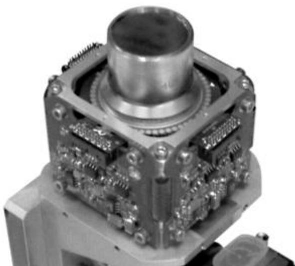
*Фото 2. ИК-матрица с защитным окном из германия в обрамлении электронных плат*
