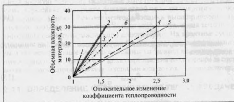
Рис. 3. Зависимость коэффициента теплопроводности строительных материалов от влажности:
