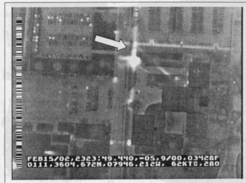
Рис. 18. Термограмма участка подземной теплотрассы, полученная аэросъемкой (с разрешения фирмы "Stockton Infrared Services")
