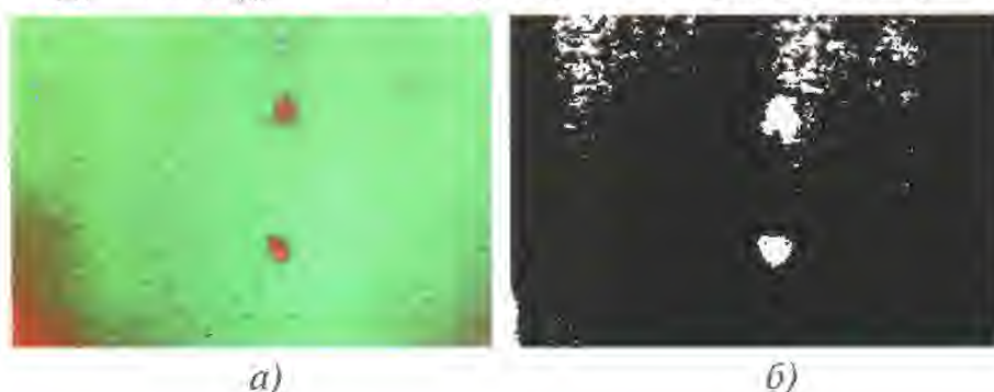
Рис. 11.52. Тепловой контроль покрытия толщиной 150 мкм: a – исходное изображение; b – карта дефектов ( P_{f,a} = 5\% , P_{c,d} = 96\% )
