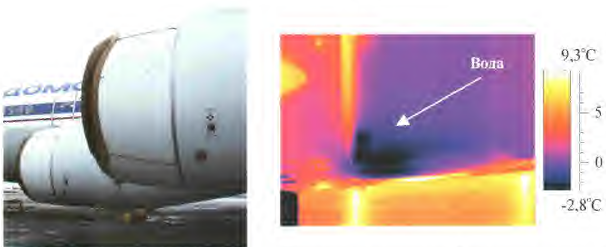
Рис. 11.45. Пассивный ТК воды в алюминиевых сотах воздухозаборников двигателей самолета ИЛ-96 (через 1 ч после посадки)
