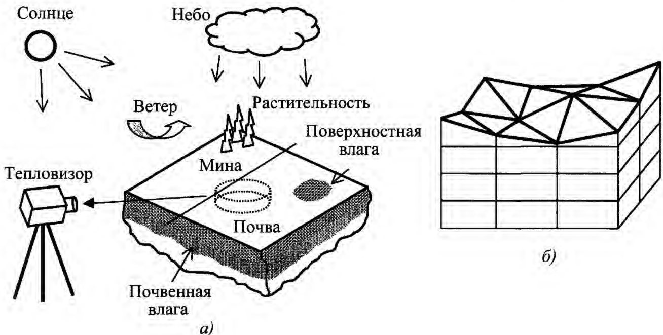
Рис. 4.41. Модель ТК мин, заглубленных в почве:
