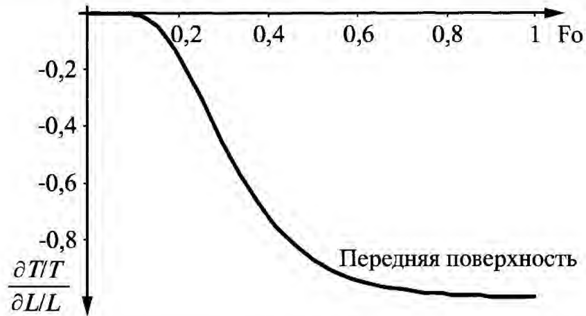
Рис. 3.5. Чувствительность температуры на передней поверхности адиабатической пластины к изменению толщины пластины
