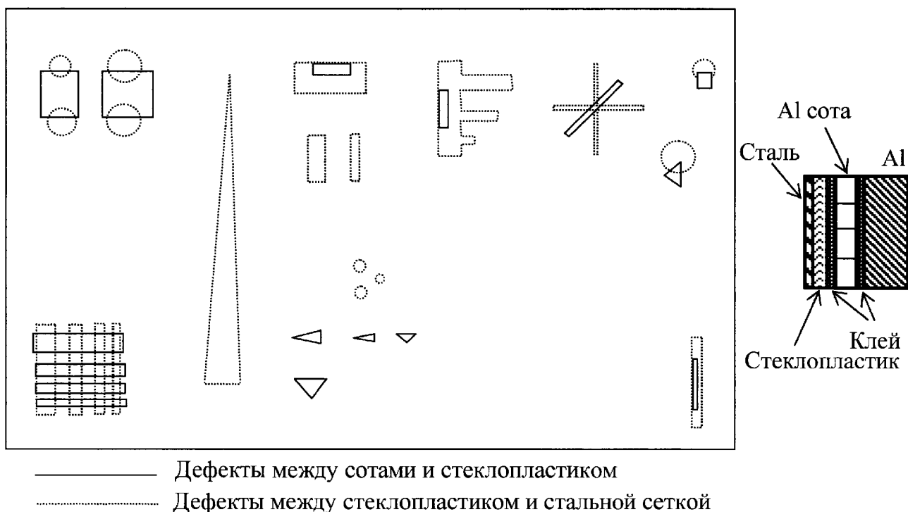
Рис. 11.43. Стандартный образец фирмы Nordam Repair Division, имитирующий дефекты воздухозаборника самолетов типа Boeing (адаптировано из [204])
