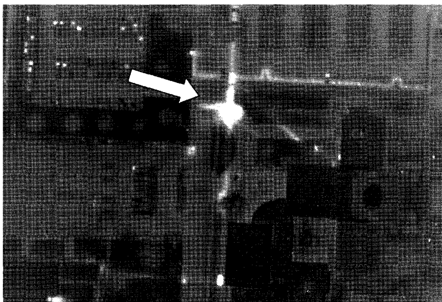
Рис. 11.41. Термограмма участка подземной теплотрассы, полученная аэросъемкой (с разрешения Г. Стоктона, Stockton Infrared Services, США)
